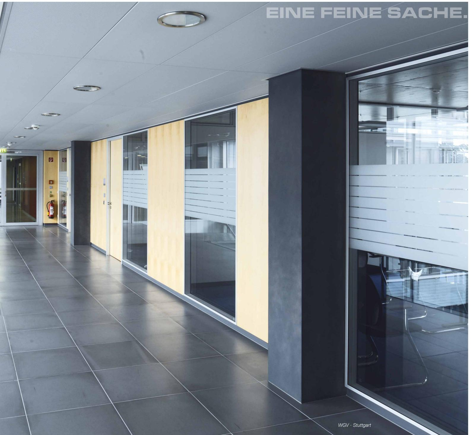
Schrägverglasungen mit integrierten Horizontallamellen
